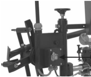
Şekil 3.1 SAW Güç kaynağı bağlantısı
