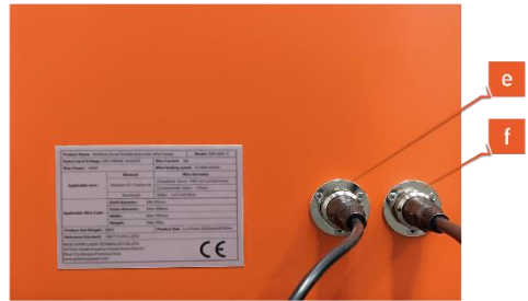
Şekil 2.2 Çift Tel Sürme Ünitesi Arka Görünüm
