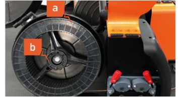
Şekil 2.1 Tel sürme yan görünüm
